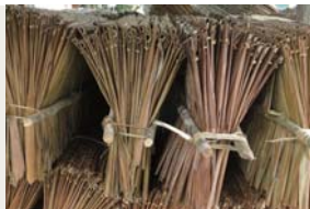
屋根葺き材のパネル化された葉
